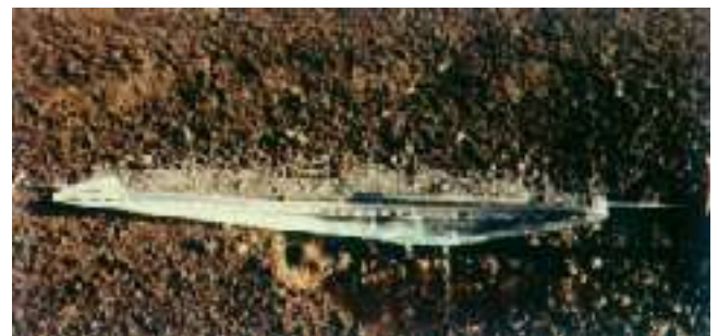
カルドレーンフィルターにより全撒水量の40～50%が排出量として測定されました。
