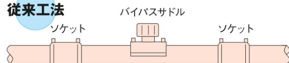
従来、結び配管時のエアパージは、短管にバイパスサドルを融着して行ったり、融着前のソケットの隙間からエアを逃がしたりしていました。
