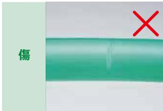
パイプの切断を途中でやめると傷が残り、トラブルの原因となります。
