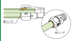
・工具を使い、袋ナットが本体に突き当たるまで締め付けます。
